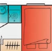
**7** Классический автомобиль гаражного типа. Двухспальная кровать размещена над полом, благодаря чему под ней остается достаточно места для гаража.
